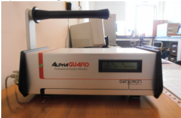
Equipo de medición de radón en continuo Alphaguard PQ 2000PRO.
