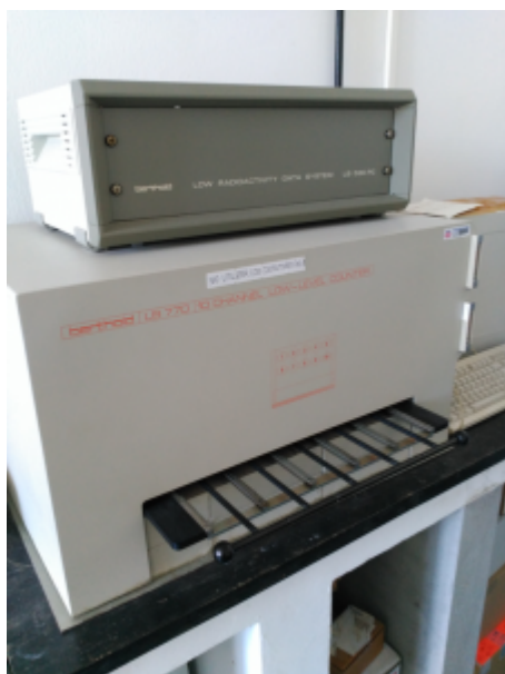
Contador proporcional alfa/beta de flujo continuo de gas Berthold LB770.
