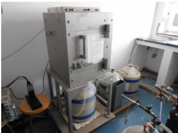
Espectrómetro gamma de Ge Canberra XTRA GX6020.
